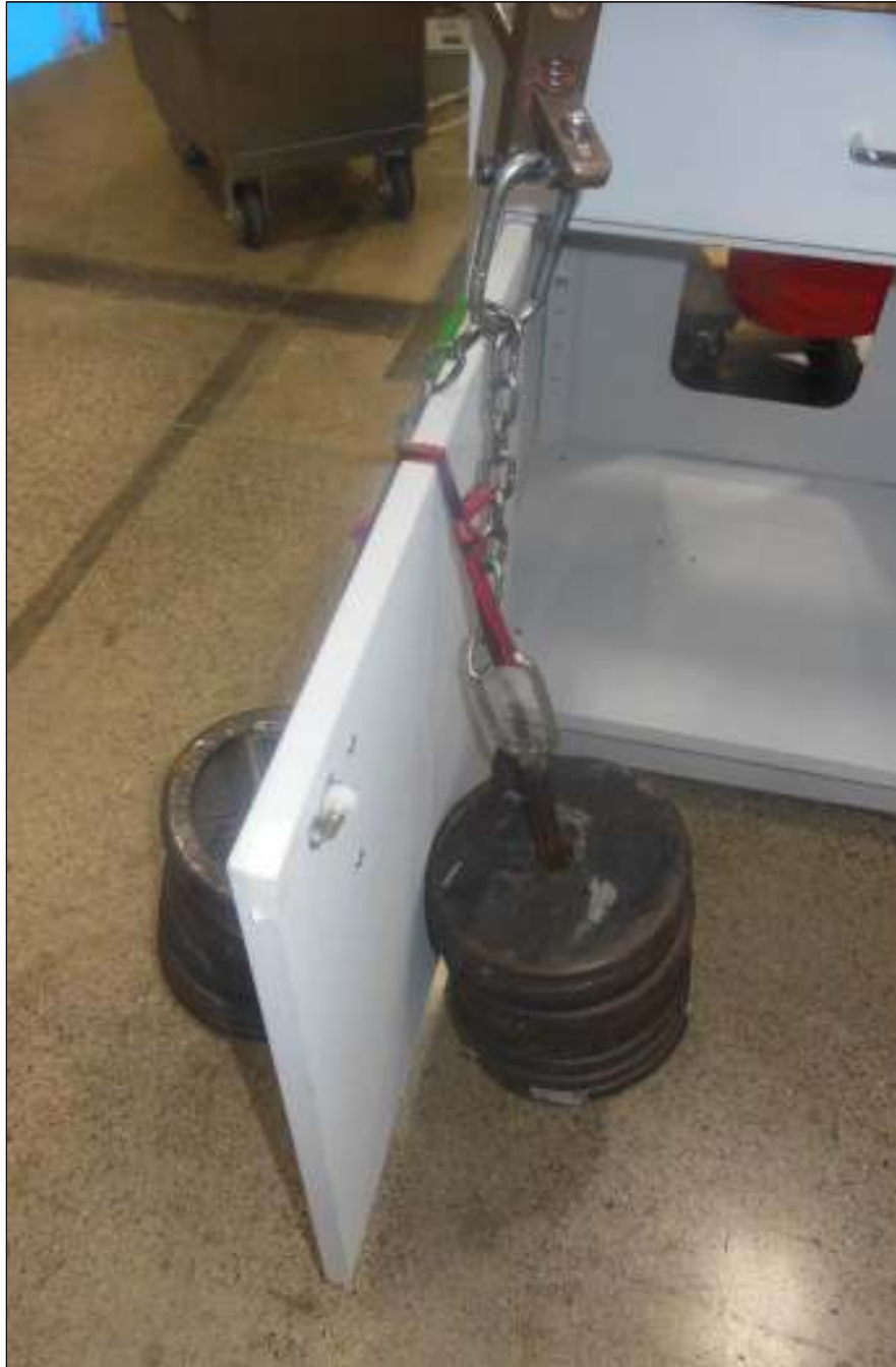
Door Hinge Test
