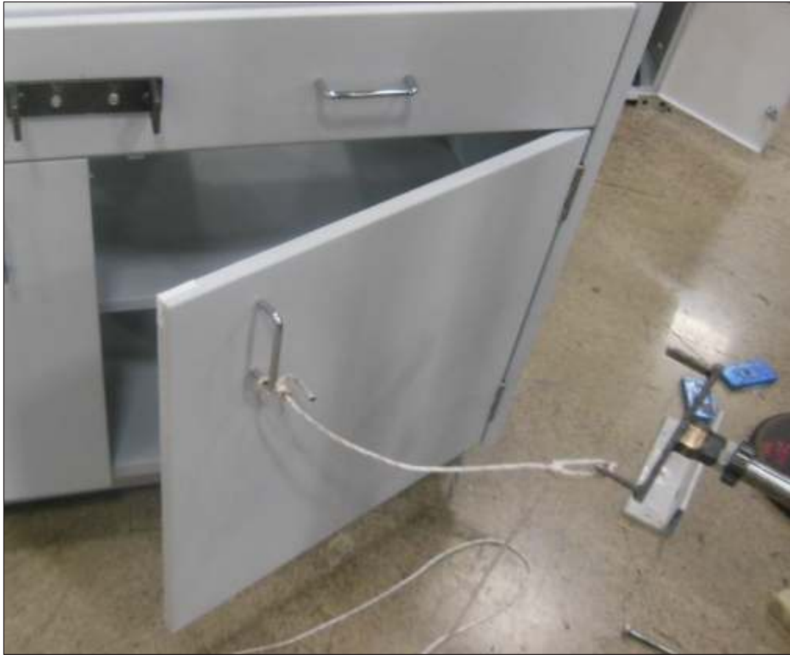
Door Cycle Test
